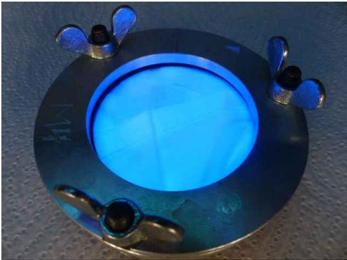
Widerstandsfähigkeit gegen Flüssigkeitsspritzer: Die Maske lässt keine Prüfflüssigkeit durch
