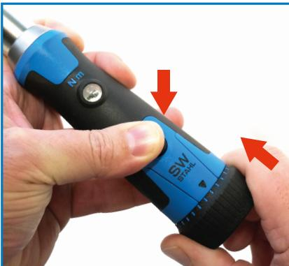
Drücken Sie den Sicherungsknopf am Handgriff und schieben Sie gleichzeitig den Einstellring hinein
