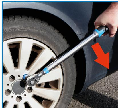
Drücken Sie den Drehmomentschlüssel in der Mitte des Handgriffs in Uhrzeigersinn und stoppen Sie direkt nach einem Klick-Geräusch
