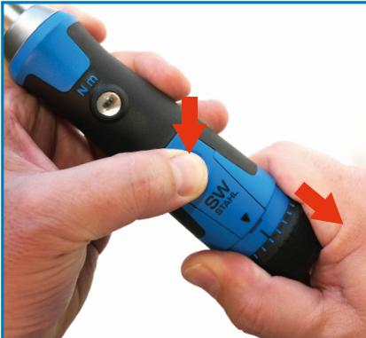
Drücken Sie den Sicherungsknopf am Handgriff und ziehen Sie gleichzeitig den Einstellring heraus
